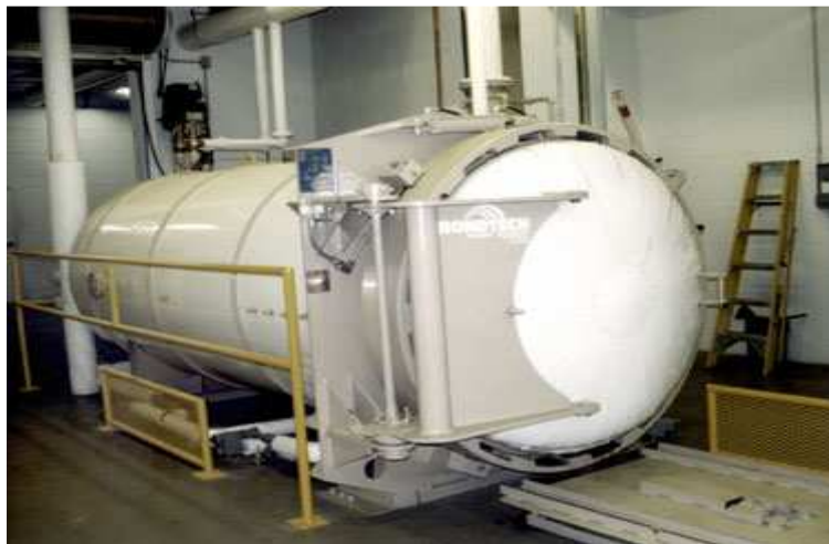
Εικόνα 16. Κλίβανος αποστείρωσης μολυσματικών αποβλήτων
